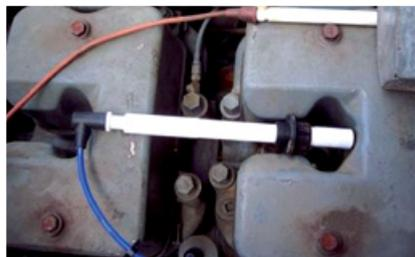
Сравнение стандартного провода (тонкий) с MOTORTECH PolyMot™
